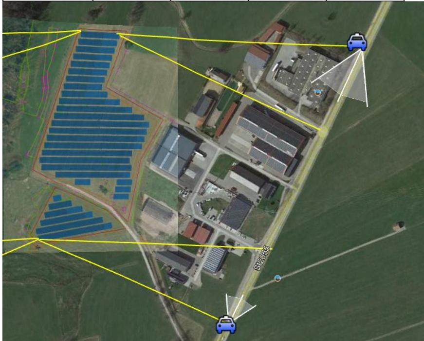
Abbildung 14: Auftretende Reflexionen in gelb und Blickwinkelberücksichtigung im Straßenverkehr
